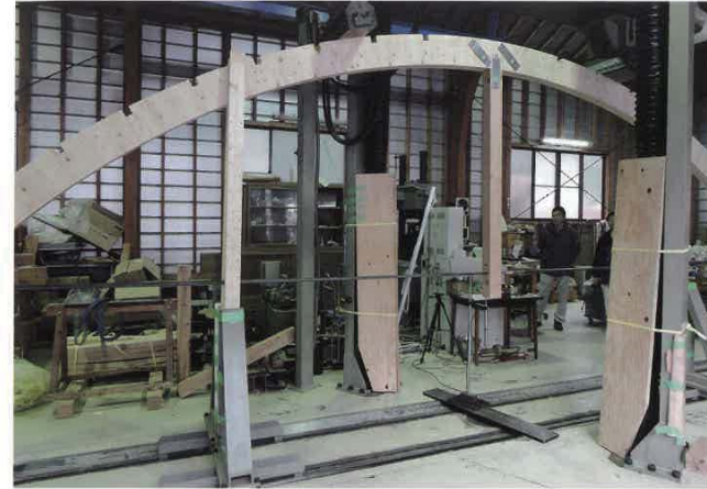
信州大学との共同による強度試験で高い荷重性能が実証された
