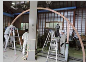
信大工学部教授、学生がフレーム強度試験
