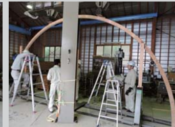
信大工学部教授、学生がフレーム強度試験
