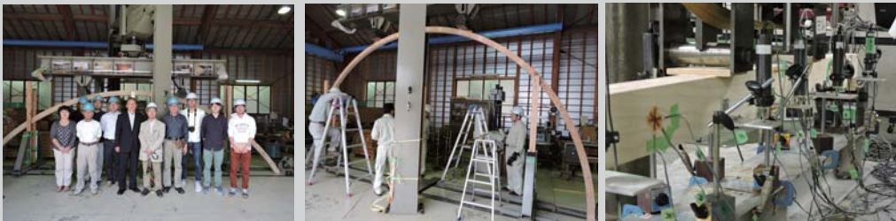
信大工学部教授、学生がフレーム強度試験
